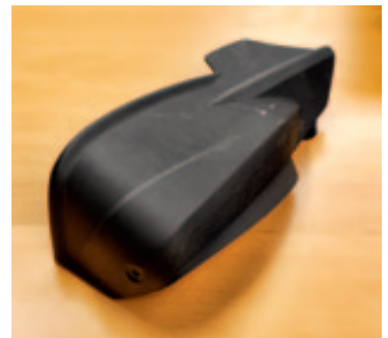
High-Tech pur: Mit unserem 3D-Drucker erstellen wir über Nacht die ersten Prototypen aus ABS-Kunststoff
