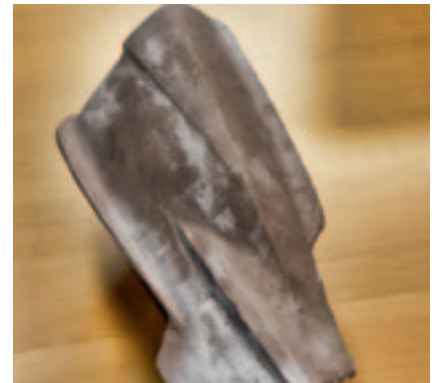
Aus der Zeichnung entsteht ein Roh-Bauteil aus Claytone
