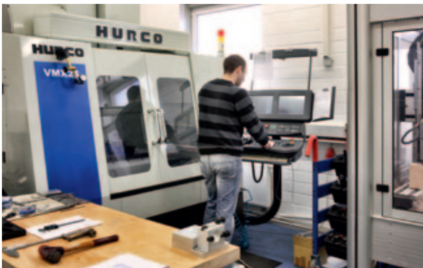
Wunderlich - Fräszentrum mit automatischem Werkzeugwechsel, so dass auch rund um die Uhr z.B. aufwändige Formen voll automatisch entstehen
