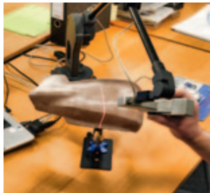
Erfassung des Claytone-Modells per Laser-Scan
